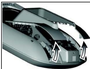
**Рис. 24:** Снятие кожуха доступа с консоли P80
